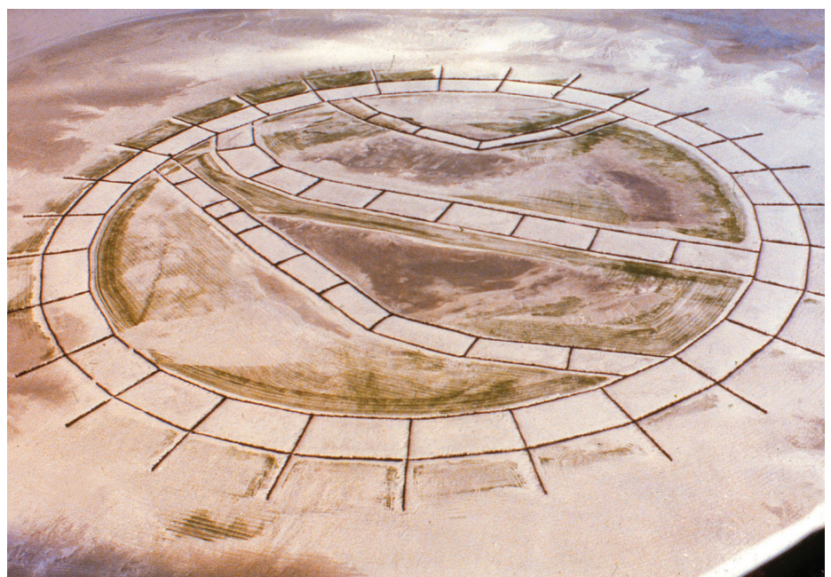
Sandfangzäune bilden das „Gerippe“ der neuen Insel Nigehörn.
